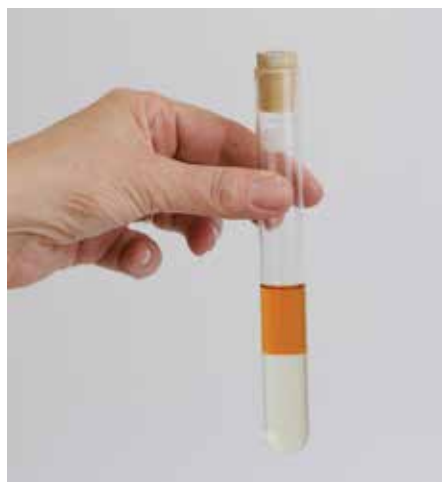
Figura 1 – Comportamento do iodo diante da solução aquosa de iodeto de potássio (KI) e butan-1-ol.
