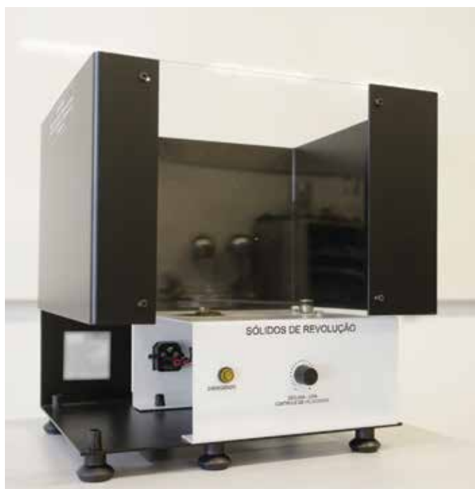
Figura 18. Aparelho denominado sólidos de revolução. Nele, há um eixo que gira rapidamente, permitindo a visualização de sólidos, quando nesse eixo estiver preso um polígono construído em cartolina/papelão.
