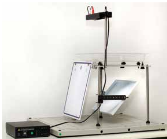
Figura 12 – Conjunto de cuba de ondas.
