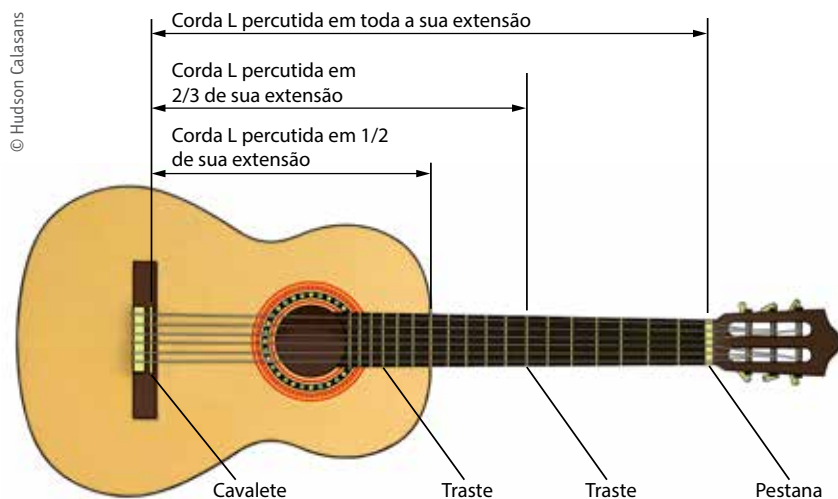
Figura 14 – Esquema com a estrutura de um violão e indicações dos comprimentos de corda.
